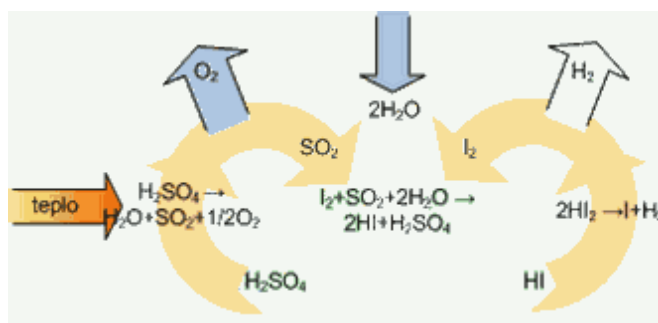
Obr. 9: Schéma SI procesu štěpení vody [9]
