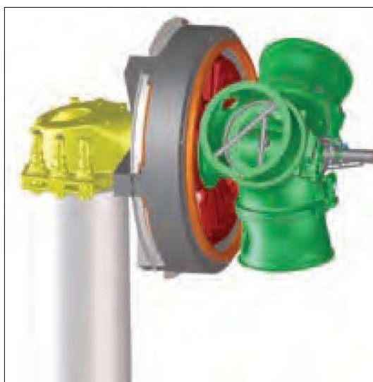
Obr.23: Mechanické spojení zařízení uvnitř gondoly
