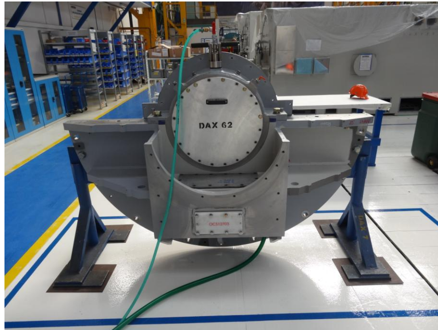
Obr. 11 Probíhající tlaková zkouška štítu
