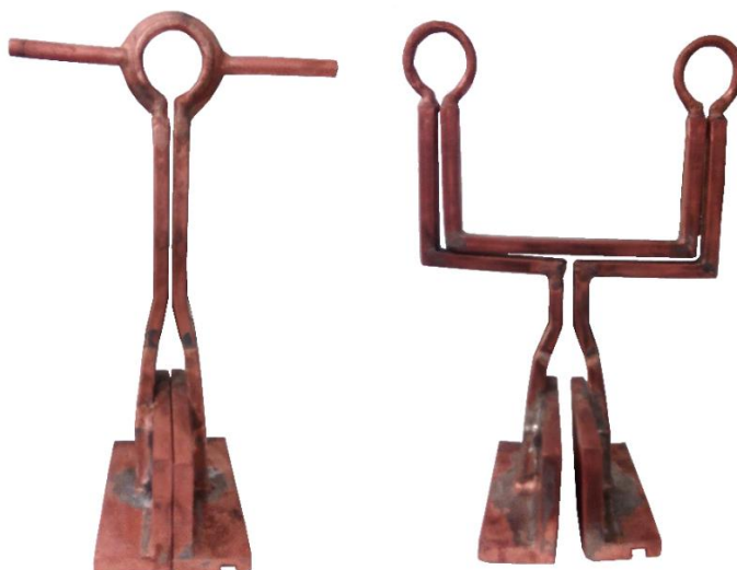
Obr. 7 Příklad induktoru pro kalení se zabudovanou sprchou vlevo a pro dvojité kalení jedním induktorem vpravo
