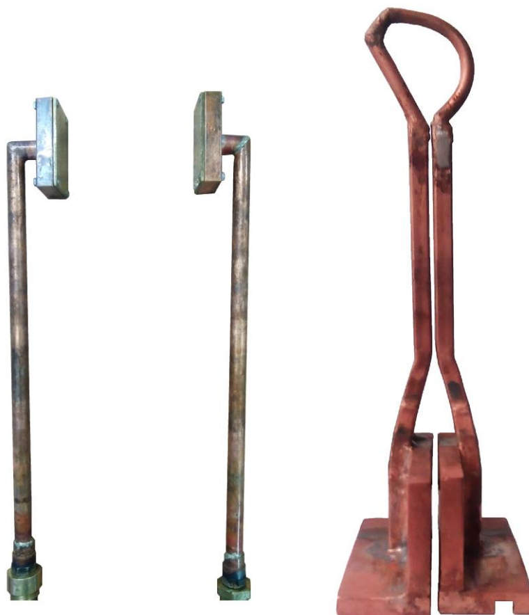
Obr. 34 Výsledný induktor na obrázku vpravo a vodní sprcha vlevo
