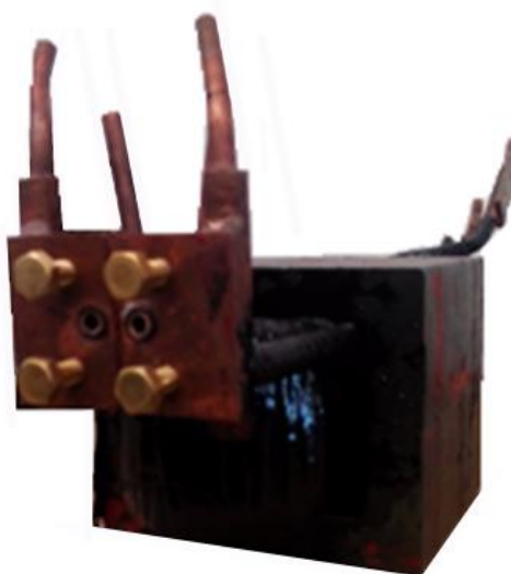
Obr. 6 Příklad provedení transformátoru a uchycení induktoru
