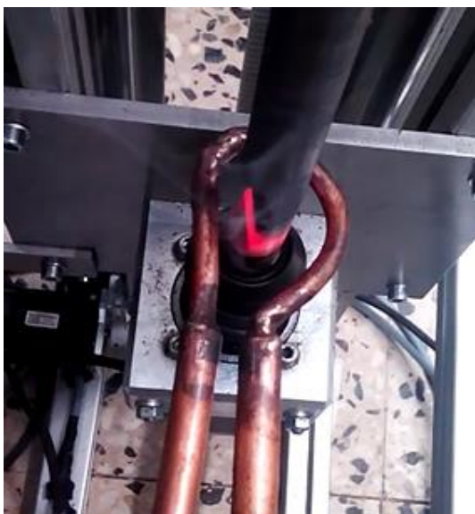
Obr. 38 Zobrazení ohřevu v čase 4 s, první fáze bez feritu
