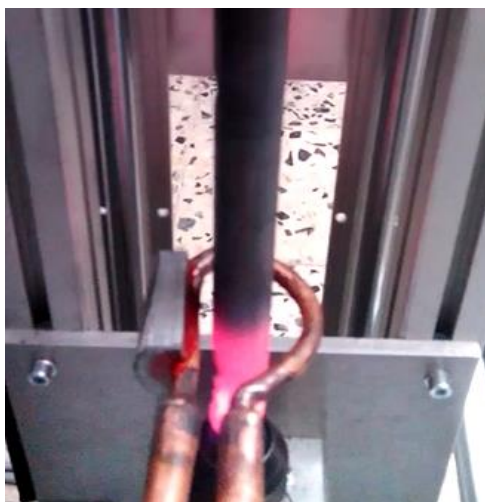
Obr. 37 Zobrazení ohřevu v čase 2 s, první fáze
