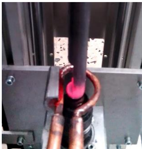
Obr. 36 Zobrazení ohřevu v čase 3 s, první fáze
