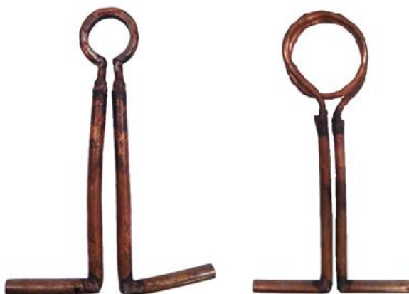
Obr. 39 Pokusné induktory s průměry 18 mm vlevo a 34 mm vpravo
