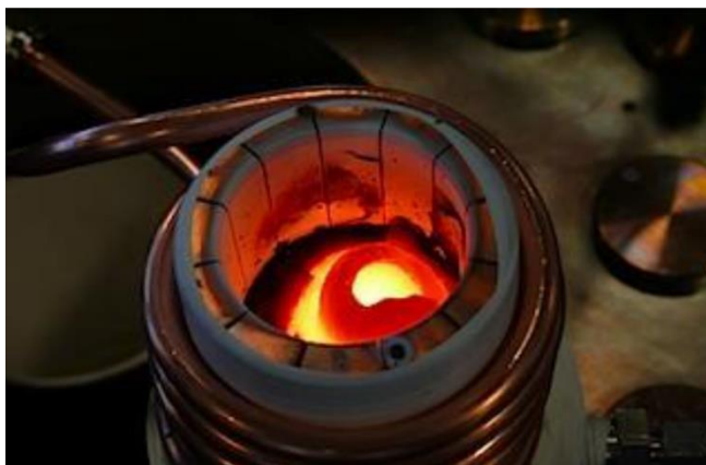
Obr. 4.2 Ukázka tavení v segmentovém kelímku [Převzato z [27]]
