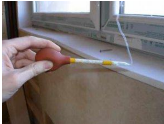
Obr.1.8.2-1 Detekce netěsností detekční kouřovou trubicí (převzato z:[35])
