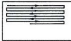
Obr. 1.23 Pohyb laserového paprsku při povrchovém kalení příčně lineární (převzato z [24])
