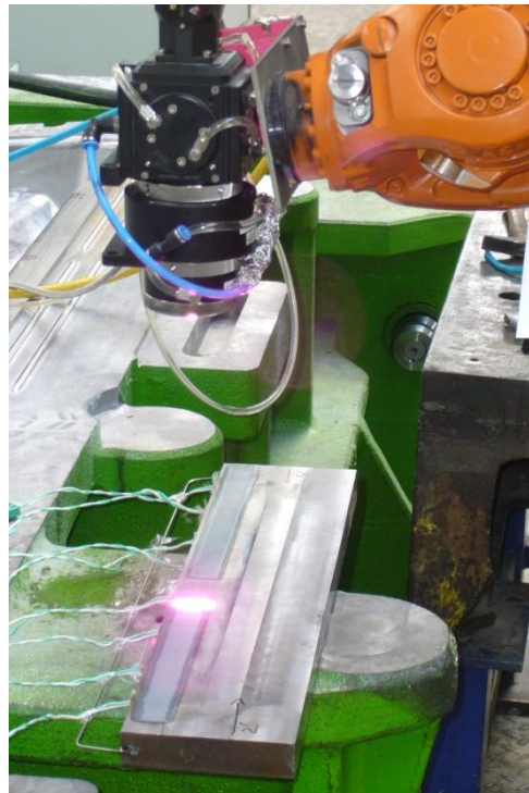
Obr. 5.8 Průběh laserového kalení při prováděném experimentu pro rychlost 2 mm/s
