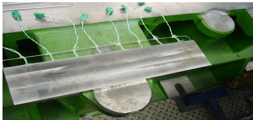
Obr. 5.2 Deska s termočlánky před laserovým povrchovým kalením
