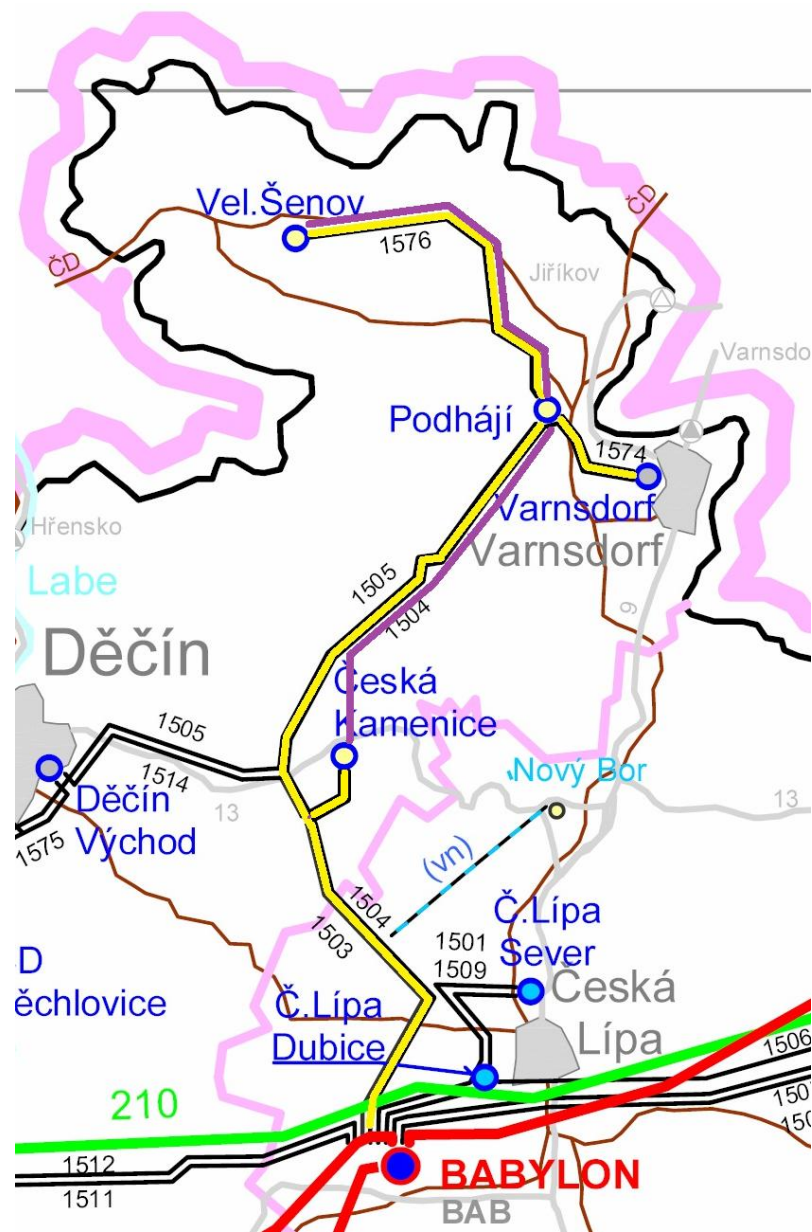
Obr.1 Vedení 110 kV Šluknovský výběžek [4]
