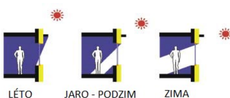
Obr. 5: Princip ochrany proti přehřívání interiéru[10]
