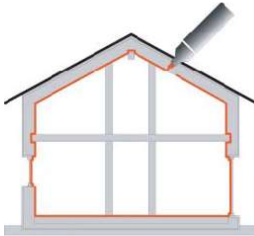
Obr. 6: Znárodnění neprůvzdušnosti obálky budovy [10]
