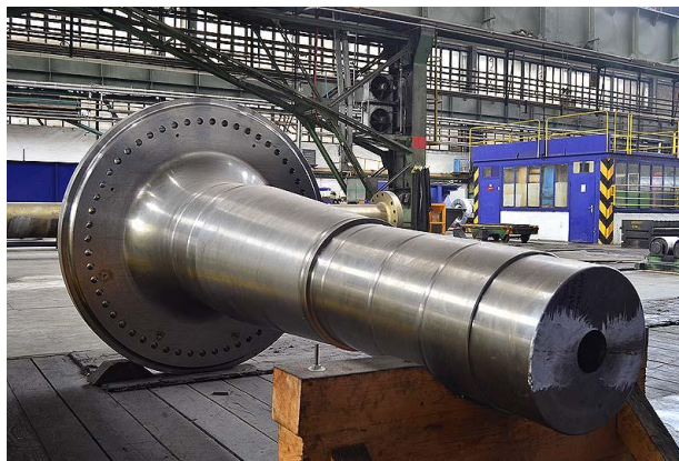
Obr. 2.12 Hřídel rotoru vyrobená ve firmě Vítkovice Steel [10]
