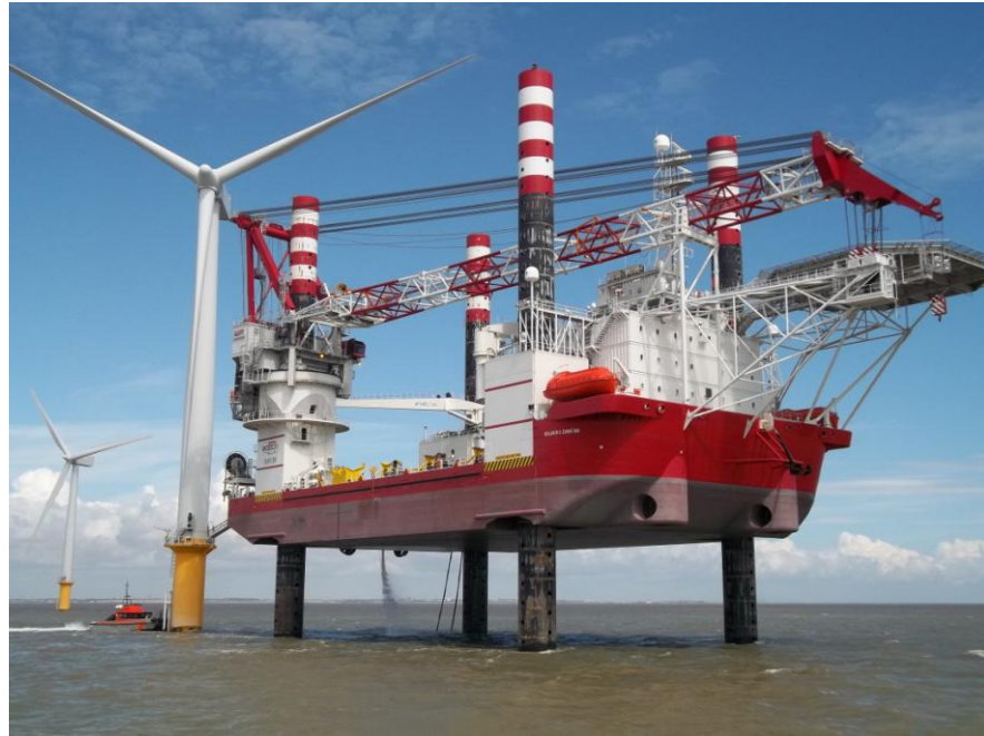
Obr. 3.7 Seajacks Zaratan během instalace VtE [4]
