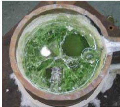
Zkrystalizované sklo po použití plynového hořáku [11]
