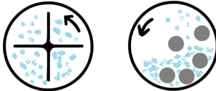
Obrázek 6: Vlevo kladivový mlýn, vpravo kulový mlýn
