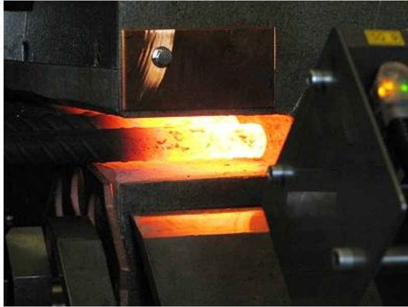
Obr. 12 Indukční ohřev konců tyčí [17]
