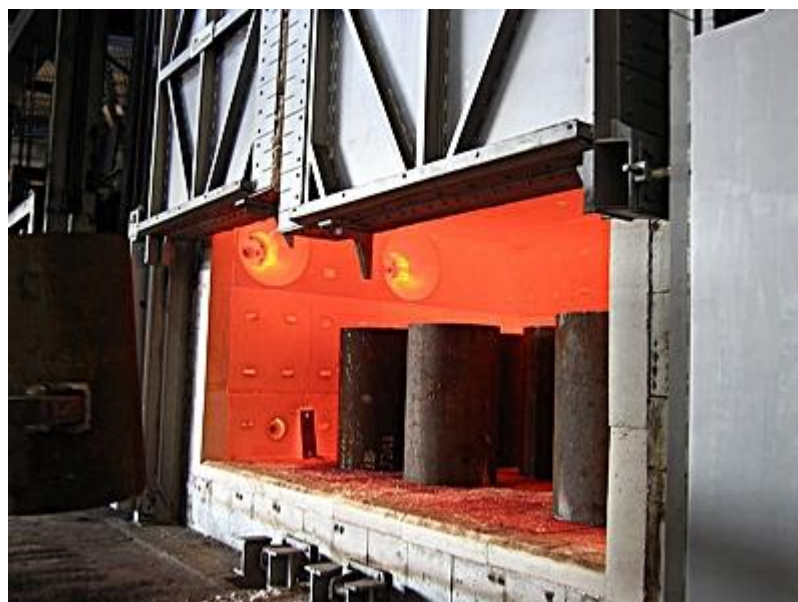
Obr. 20 Komorová pec pro ohřev [25]
