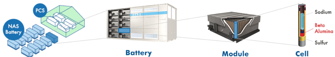
Obr. 19: Sestavení Na-S akumulátoru [28]
