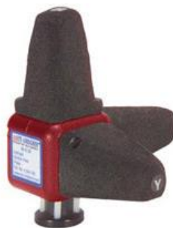
Obr. 4.8: Sonda elektrického pole [15]
