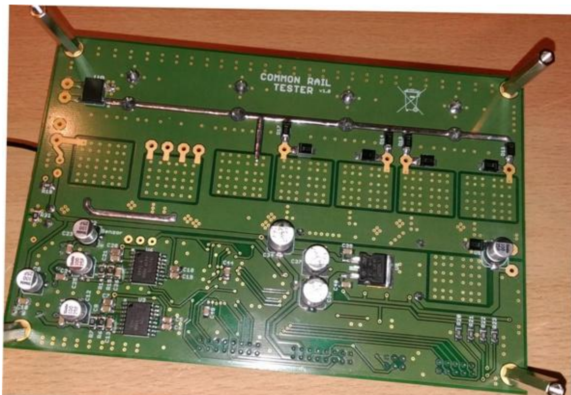
Obr. 6.2 DPS řídicí a výkonová část – vrstva BOTTOM
