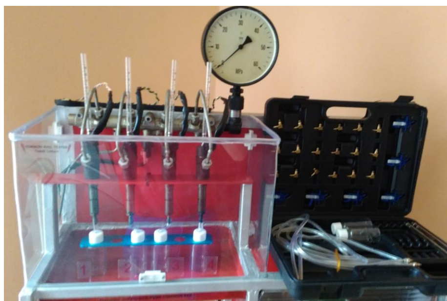
Obr. 9.4 Kufř s měřicí sadou a zapojení vstřikovačů při měření množství paliva
