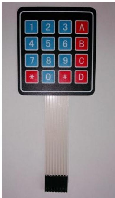
Obr. 5.13 Použitá maticová klávesnice s rozměry 4x4
