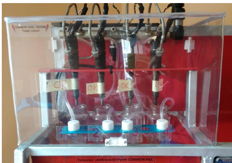
Obr. 9.3 Zapojení vstřikovačů a měřicí sady pro test tvaru paprsku
