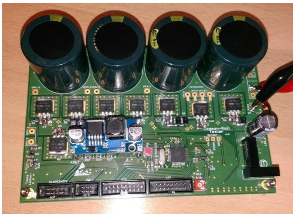
Obr. 6.3 DPS řídicí a výkonová část – vrstva TOP
