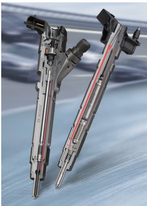
Obr. 1.16 Řez elektromagnetickým vstřikovačem (vlevo) a piezoelektrickým vstřikovačem (vpravo) [10]
