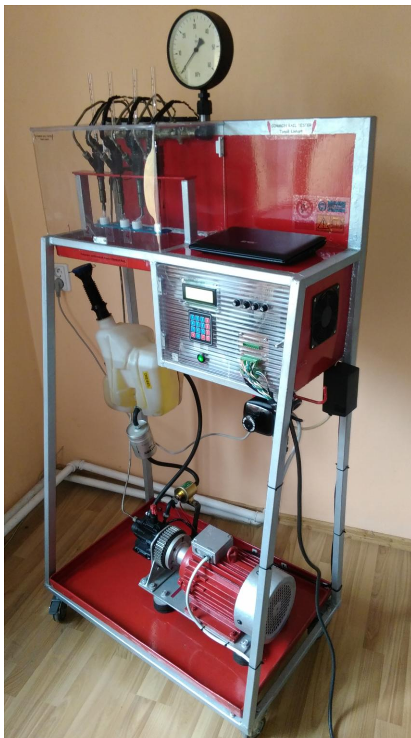
Obr. I.1 Kompletní a výsledná podoba testeru vstříkovačích trysek
