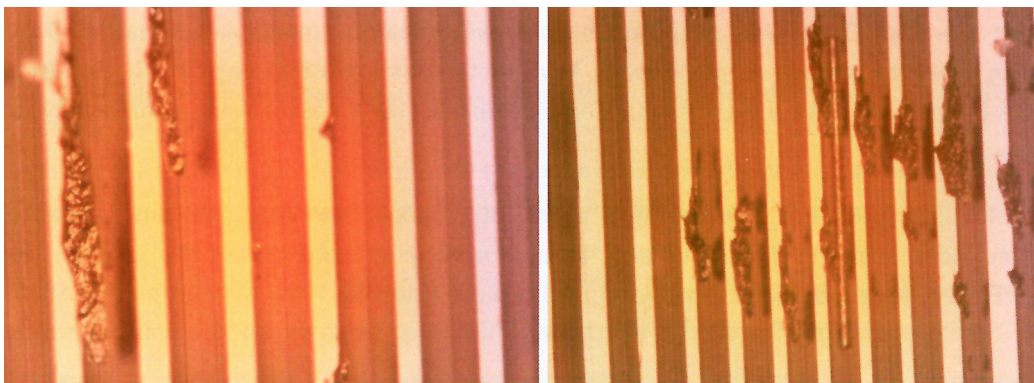
Obr. 2 - Ukázka vady nedolisy - fotografie z mikroskopu [1]
