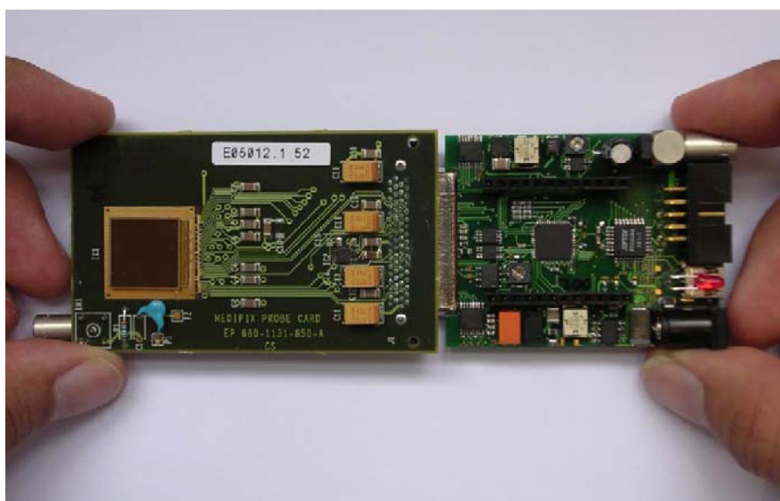
Obrázek 18.: Deska plošného spoje systému USB 1.22 Interface (vpravo) s připojeným detektorem Medipix2MXR (vlevo).
