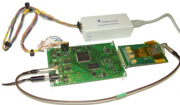
Obrázek 45.: SATPix prototyp s detektorem Timepix a SpaceWire převodníkem na USB.
