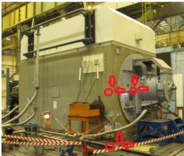
Obr. č. 61: Umístění snímačů vibrací na smontovaném stroji
