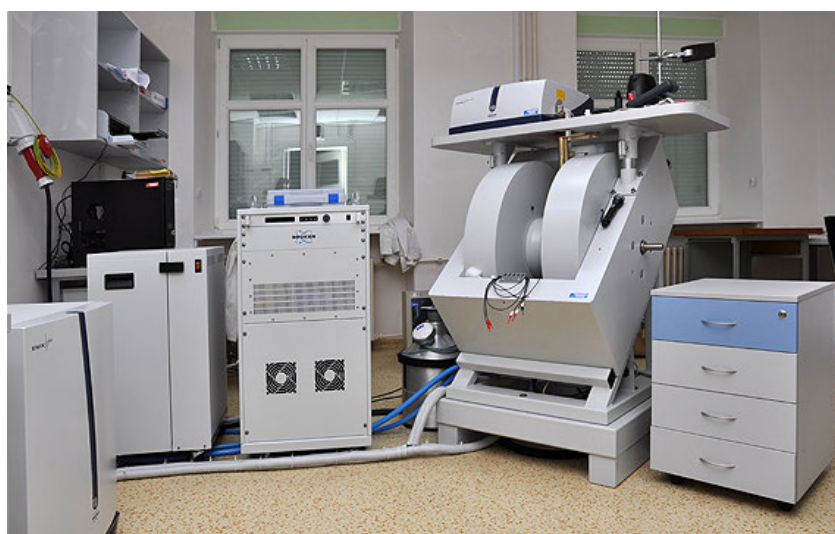
Obr. 4.2: EPR spektrometr Bruker EMX Plus v laboratořích Ústavu organické chemie a biochemie AV ČR. [Převzato z: http://www.uochb.cz/ ]
