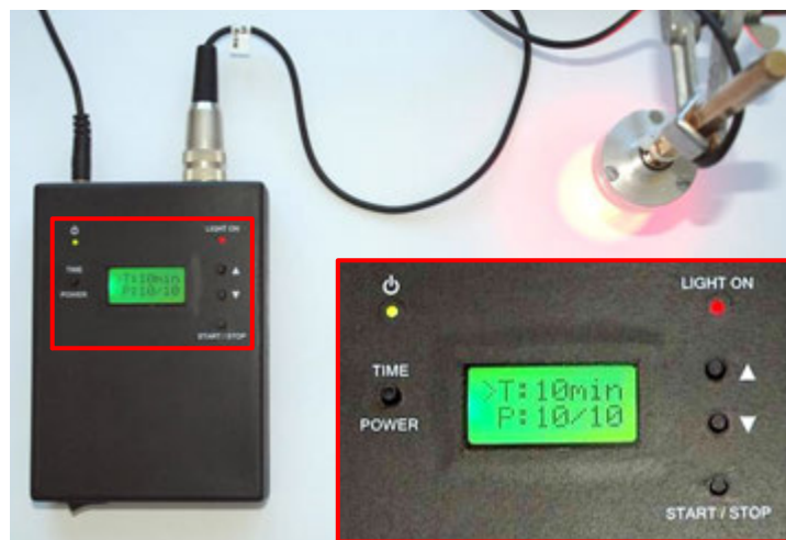
Obr. 7.31: Univerzální řídicí jednotka a detail předního panelu.
