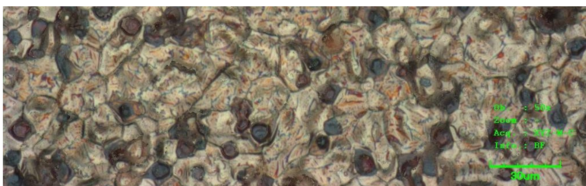
Obr. 14 Povrch měděné vrstvy, která byla vypálena při průtoku dusíku 25 l/min. Olympus OLS 3000; barevný mód, světlé pole.
