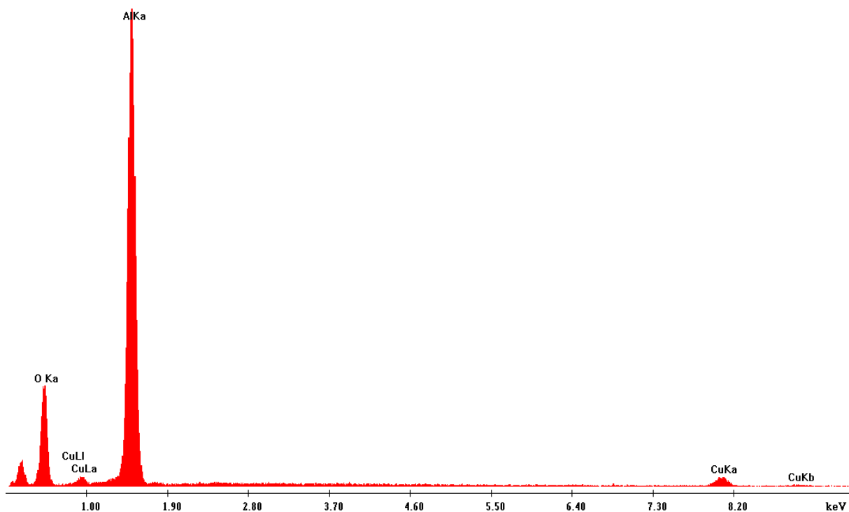
Obr. III. Prvkové složení v závislosti na energii – oblast 4.
