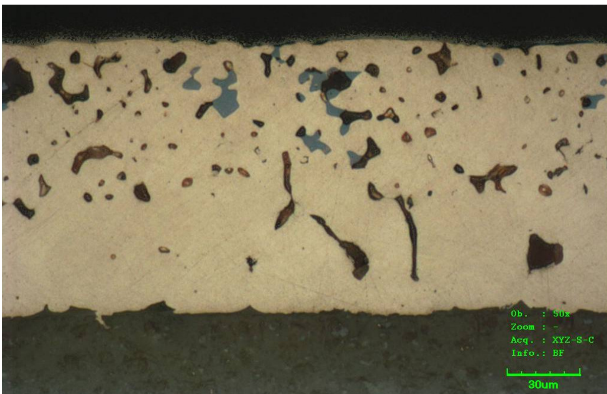
Obr. 18 Metalografický výbrus měděné vrstvy, která byla vypálena ve vakuové peci. Olympus OLS 3000; barevný mód, světlé pole.
