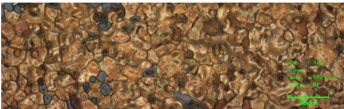
Obr. 17 Povrch měděné vrstvy, která byla vypálena ve vakuové peci. Olympus OLS 3000; barevný mód, světlé pole.
