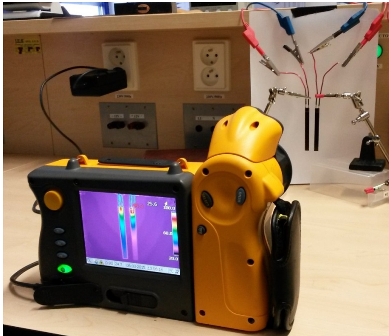
Obr. 36 Princip měření přestupu tepla na testovacích motivech ve tvaru proužků. Pro měření byla použita termokamera FLUKE TI55.
