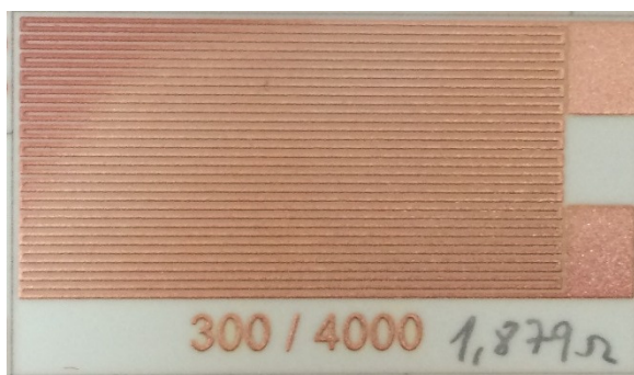
Obr. 34 Vodivý motiv, který je určený pro měření rezistivity. V závislosti na optimalizaci tisku a výpalu je šířka vodivé dráhy v meandru přibližně 300 \mu\text{m} a počet čtverců v dráze je 4000.
