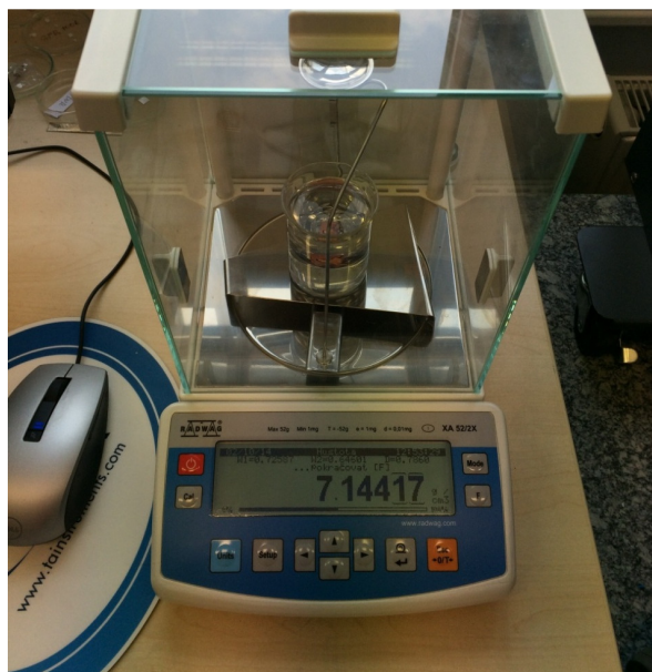
Obr. 33 Měření hustoty měděné vrstvy laboratorní váhou.
