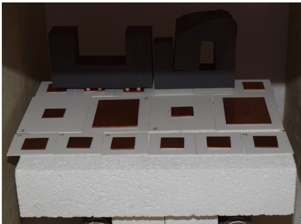
Obr. 3 Umístění vzorků v muflové peci pro výrobu substrátů technologií DBC.
