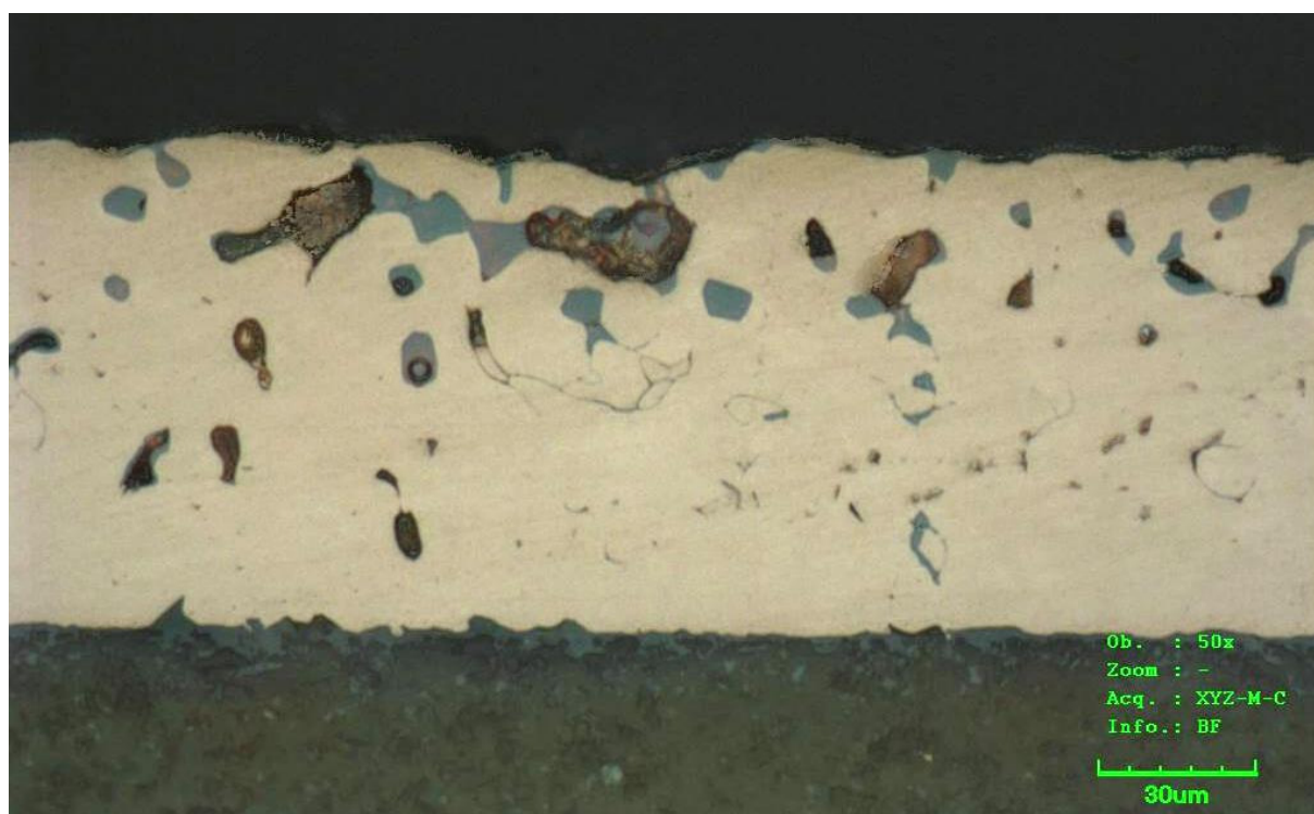
Obr. 16 Metalografický výbrus měděné vrstvy – vypáleno při průtoku dusíku 25 l/min. Olympus OLS 3000; barevný mód, světlé pole.
