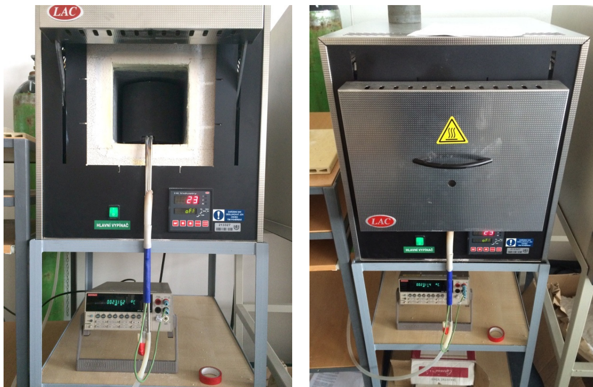
Obr. 9 Umístění plynotěsné retorty v muflové peci s otevřenými (vlevo) a zavřenými dveřmi pece (vpravo). Pod pecí je umístěn měřicí přístroj Keithley 2010, který slouží k převedení termoelektrického napětí termočlánku na teplotu.
