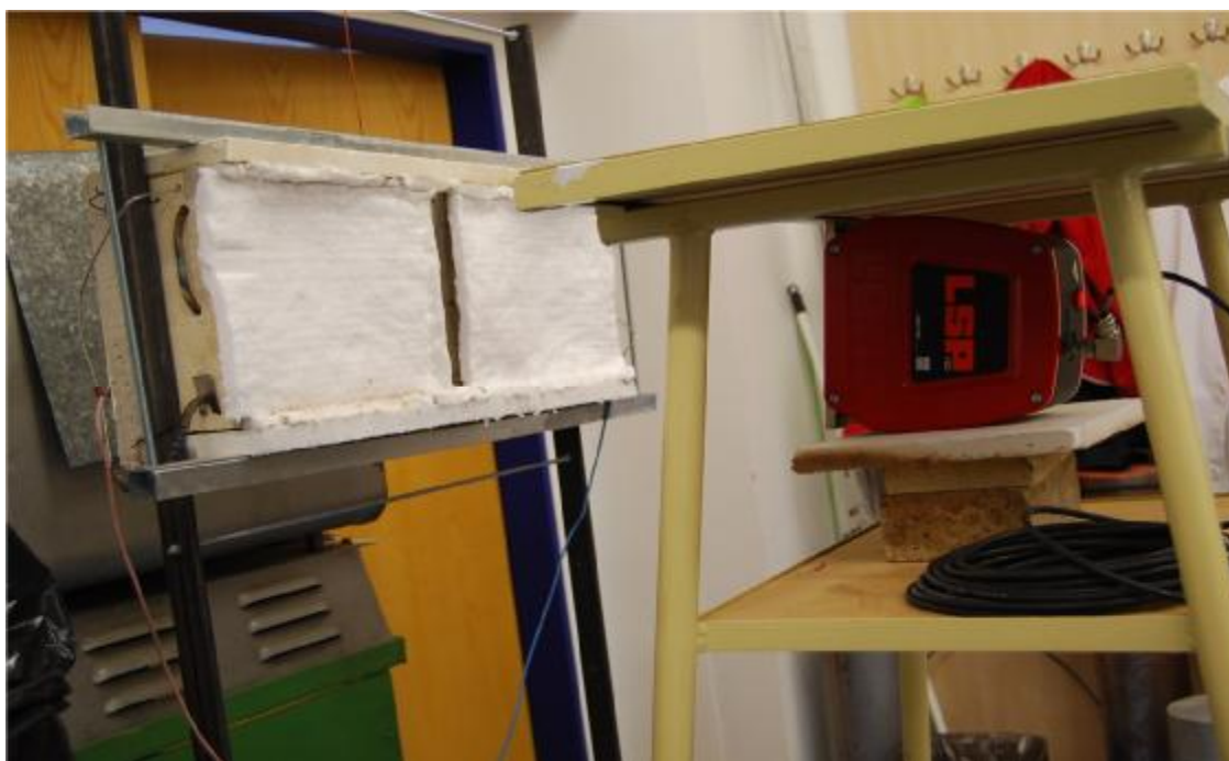
Obr. 3.2.4 Experiment – zjišťování povrchové teploty topného článku (simulující podmínky s odkrytou spirálou)
