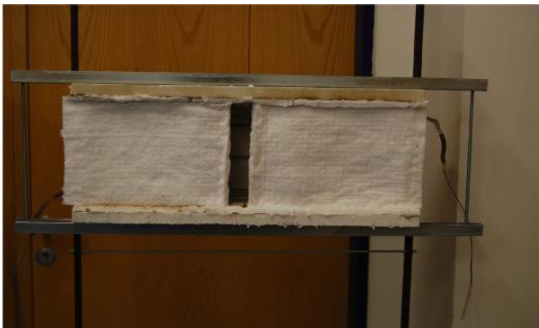
Obr. 3.2.3 Funkční vzorek topného systému muflové pece (simulující podmínky s odkrytou spirálou)
