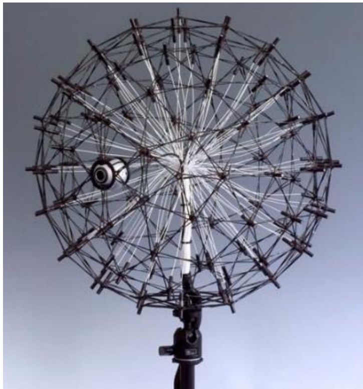
Obr. 2.2 Sférické, akusticky transparentní pole s kamerou a 120 mikrofony [13]
