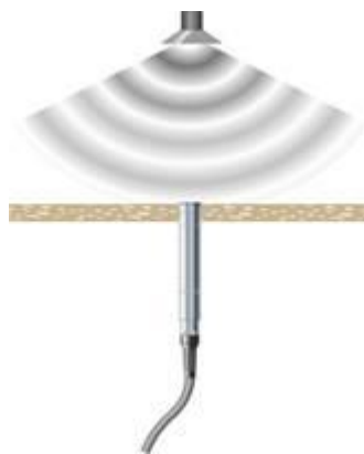
Obr. 1.3 Příklad umístění tlakového mikrofonu v desce [4]
