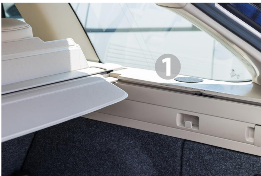
Obr. 4.5 Výškový reproduktor na pravé straně zavazadlového prostoru z pohledu řidiče, vlastní zpracování, 2016
