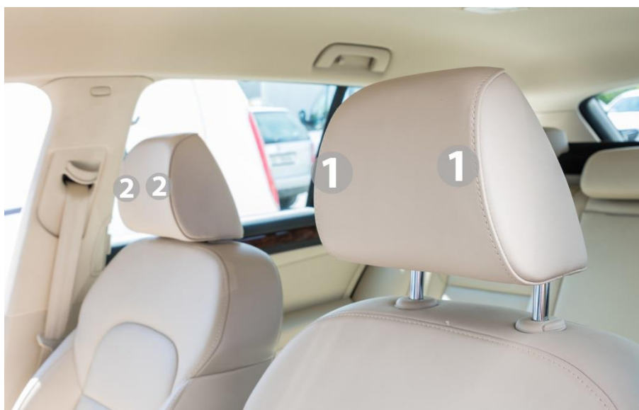
Obr. 4.10 Zabudování reproduktorů do hlavových opěrek sedadel
