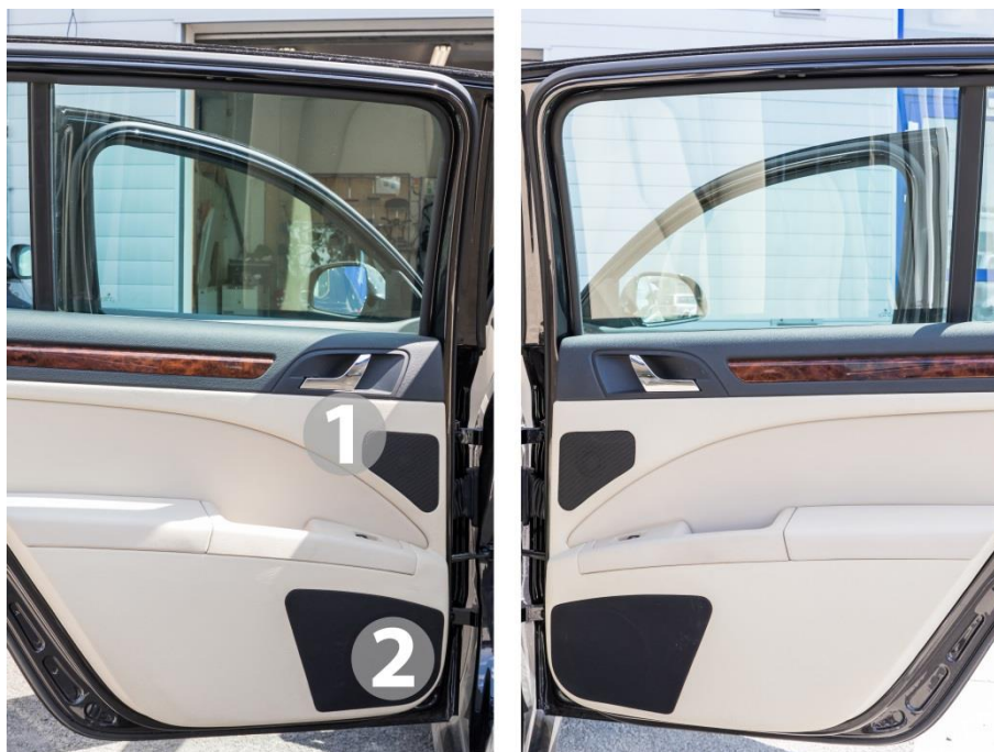
Obr. 4.3 Dvoupásmový reproduktorový systém levé a pravé strany zadních dveří, vlastní zpracování, 2016
