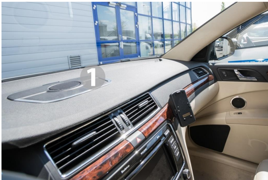
Obr. 4.4 Středový reproduktor osazený v přístrojové desce, vlastní zpracování, 2016
