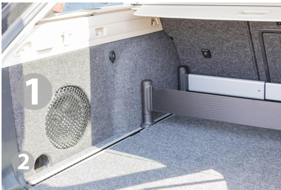
Obr. 4.6 Integrovaný subwoofer v bočnici zavazadlového prostoru, vlastní zpracování, 2016
