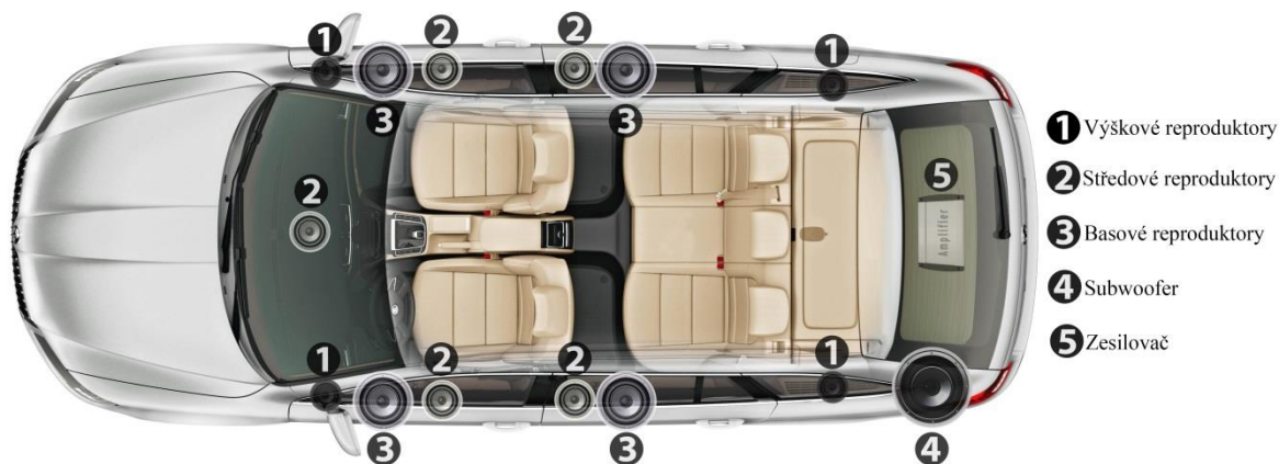
Obr. 4.1 Schéma zapojení audio systému v automobilu. Vlastní zpracování, 2016 dle [18]
