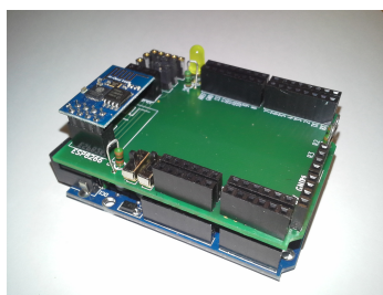
Obrázek 5.9: Shield zasazený do patice Arduina
