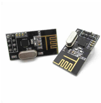
Obrázek 4.1: Proprietární 2,4 GHz modul nRF24L01+
