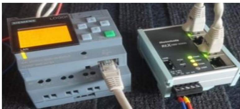
Obr.5.3 Dálková komunikace s modulem LOGO 8, převzato [14]
