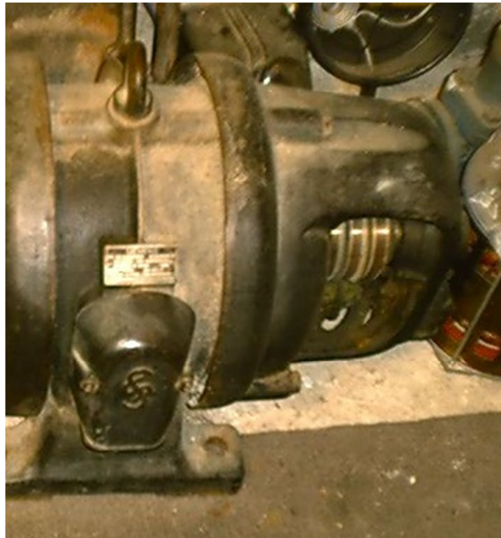
Obr. 2 – Pohled na kroužky u kotvy navinuté trojfázově [10]
