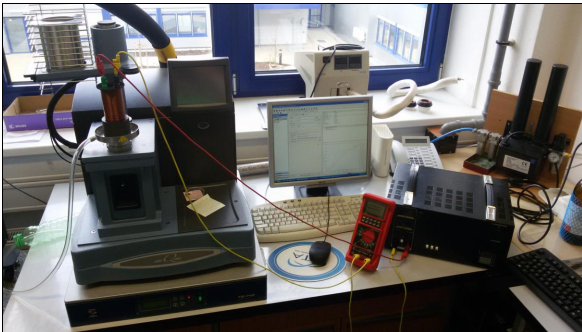
Obr. 3-6 Realizace měření magnetostrikce
