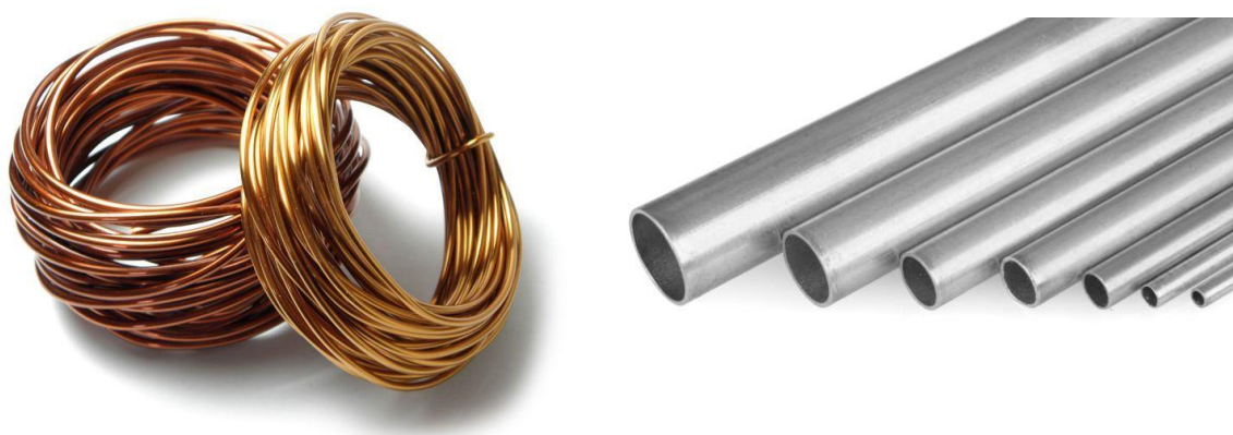
Obr. 1-2 Vlevo příklad diamagnetika-mědi, vpravo příklad paramagnetika-hliníku [13, 14]
