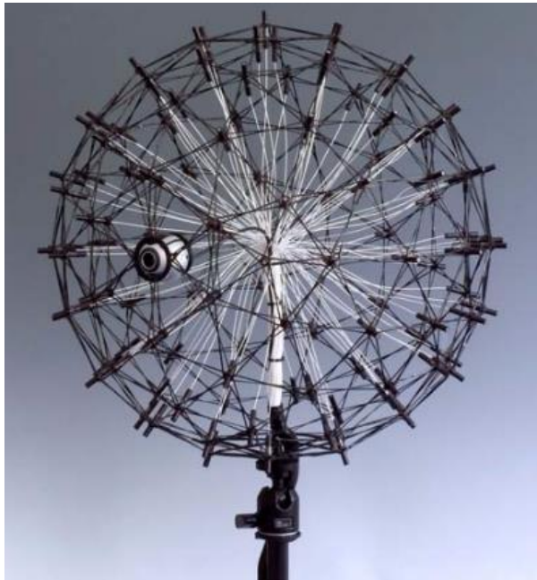
Obr. 2.2 Sférické, akusticky transparentní pole s kamerou a 120 mikrofony [13]
