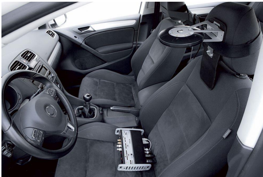
Obr. 2.5 Audison bit Tune připevněný v kabině automobilu [8]
