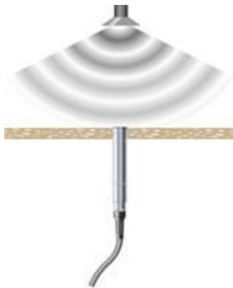
Obr. 1.3 Příklad umístění tlakového mikrofonu v desce [4]
