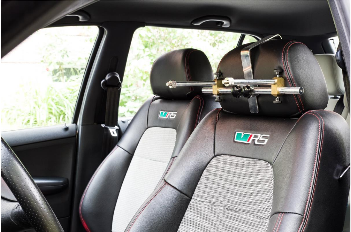
Obr. 2.4 Současný držák dvou mikrofonů připevněný na sedadle
