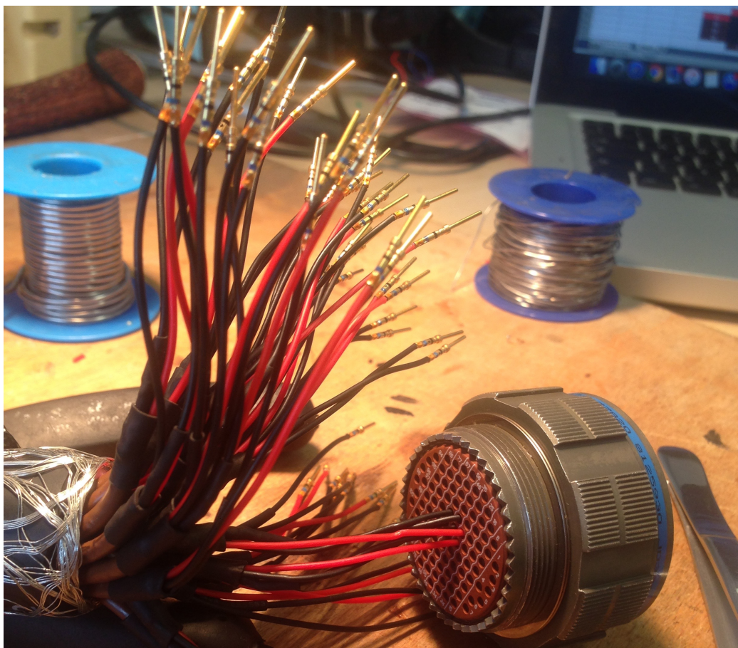
Obr. 21: Vkládání pinů do těla konektoru
