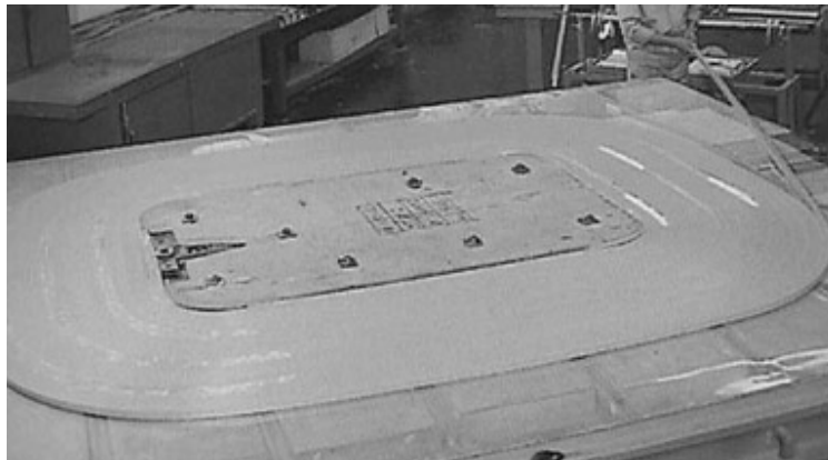
Obr. 1.3 Diskové vinutí během procesu navíjení (převzato z [5])
