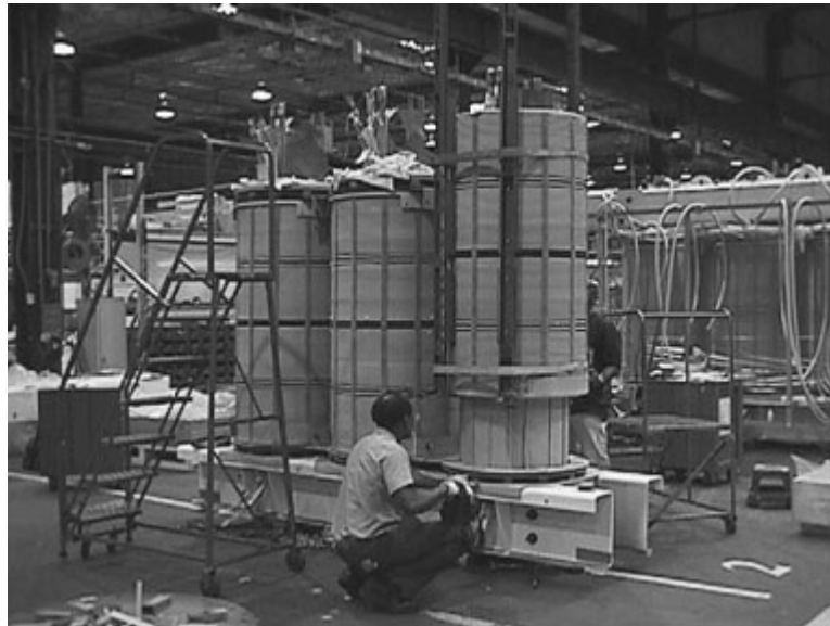
Obr. 1.2 Soustředné uspořádání - vnější cívka je nasazena na sloupek jádra přes vnitřní cívku (převzato z [5])
