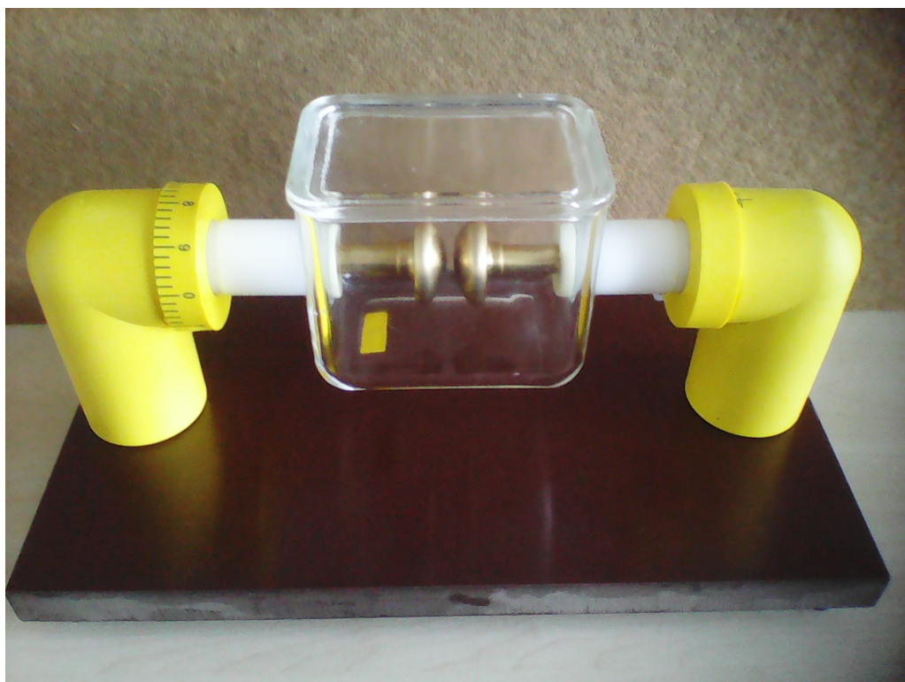
Obrázek 6: Systém měřících elektrod použitých pro testování vzorků
