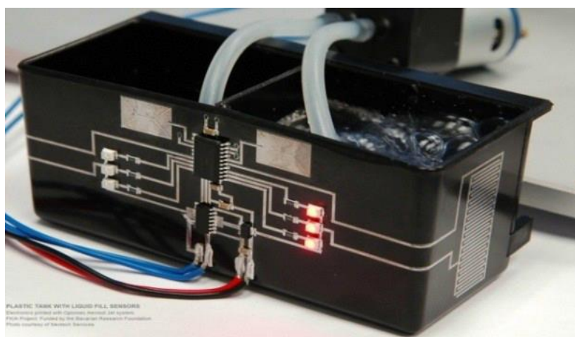
Obr. 1.9 Dvoukomorová nádrž s tištěným snímacím obvodem hladiny kapaliny (převzato z [11])
