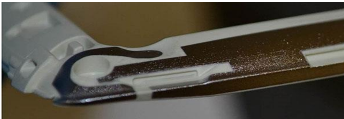
Obr. 1.6 Ukázka tištěné antény pomocí systému AJP (převzato z [15])
