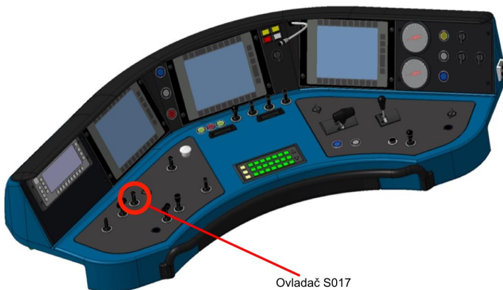
Obrázek 4 - Umístění ovladače hlavního vypínače [2]
