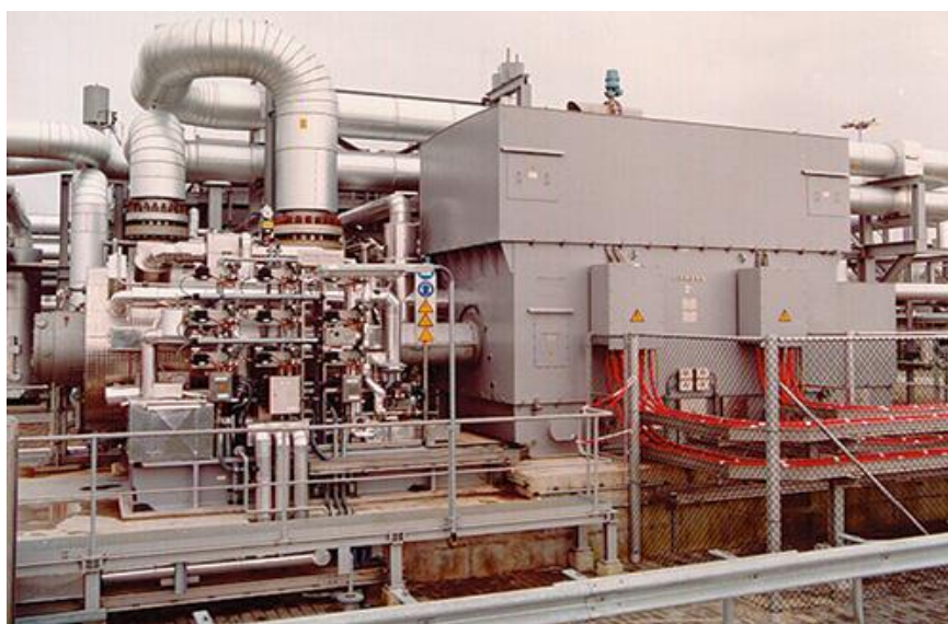
Obr. 10 Kompresor s aktivními magnetickými ložisky pro zpracování plynu (převzato z [1])
