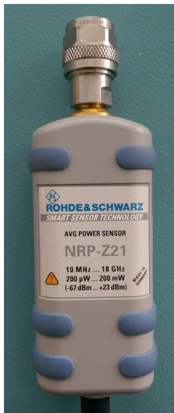
Obr. 1.1 Měřicí sonda R&S® NRP-Z21
