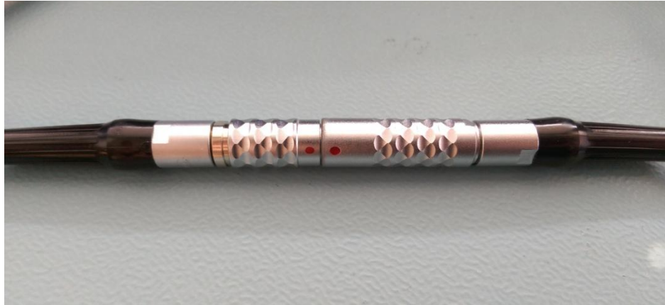
Obr. 1.5 Pasivní USB adaptér R&S NRP-Z4
