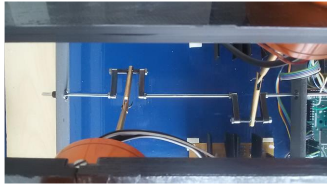
Obr. 2.10: Vlevo: návrh klikové hřídele, vpravo: reálně vyrobená kliková hřídel
