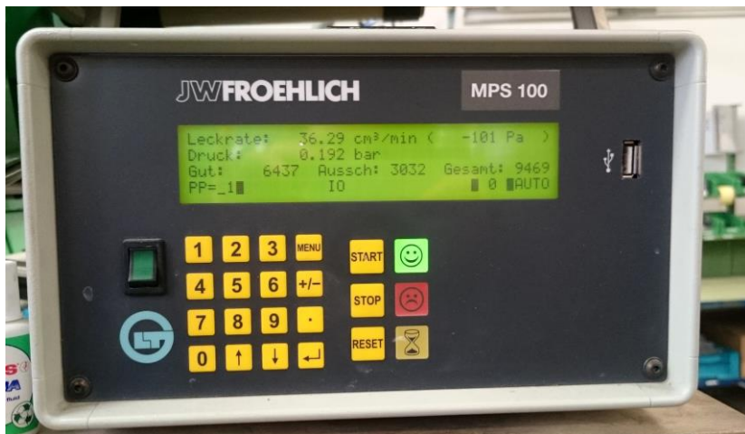
Obrázek 52: Zařízení pro kontrolu těsnosti
