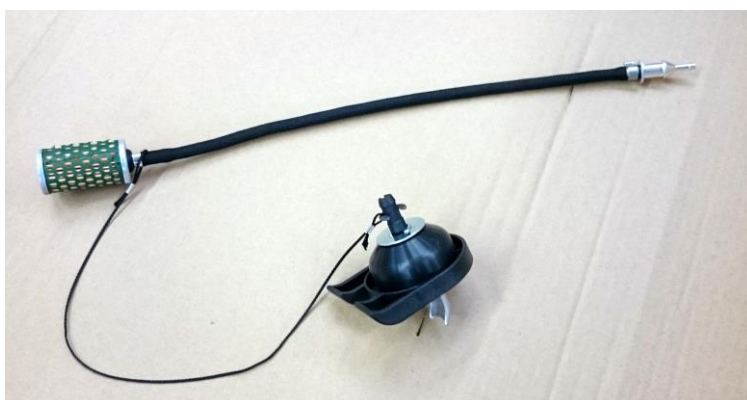
Obrázek 34: Filtrace k nádrži
