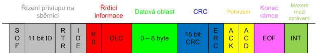
Obrázek 3.6 Formát rámce CAN 2.0A Standard [11]
