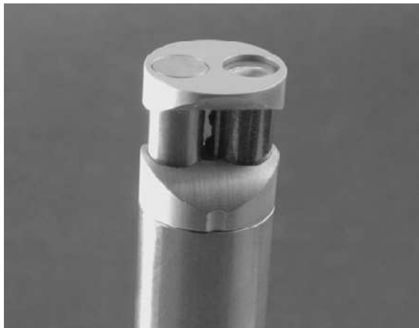
Obr. 2-5: Intenzitní sonda typu p-u od firmy Microflown. Převzato z [11]
