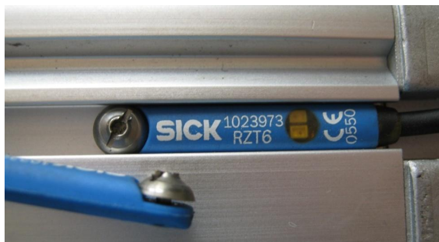
Obr.5-2-3: Čidlo polohy pístu v T-drážce a čidlo z bočního pohledu
