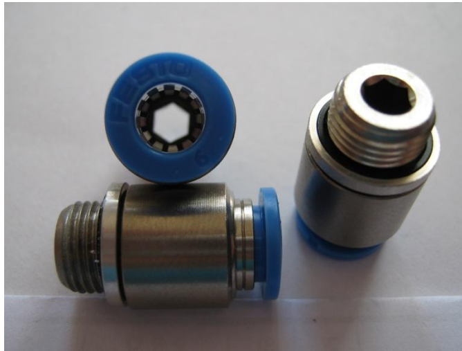
Obr. 3-1: Šroubení FESTO, 6mm hadice, závit 1/8
