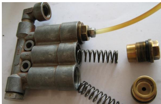
Obr. 2-4: Rozdělovač s integrovaným regulátorem průtoku
