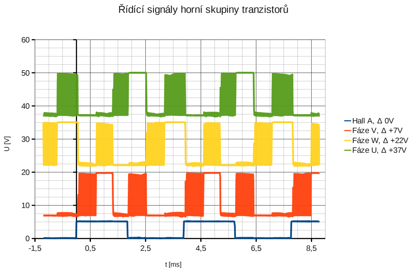
Graf 3: Průběhy napětí řídicích signálů horní skupiny tranzistorů 3-fázového můstku
