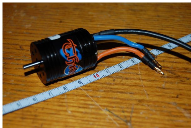
Ilustrace 3: BLDC motor pohánějící robota
