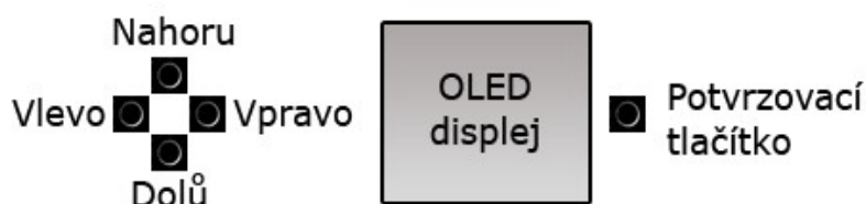
Ilustrace 16: Místní ovládání embedded zařízení
