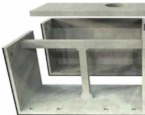
OBRÁZEK Č. 10 - PREFABRIKOVANÉ DÍLY PRO NÁDRŽE JÍMKY NA SILÁŽNÍ ŠTÁVY
