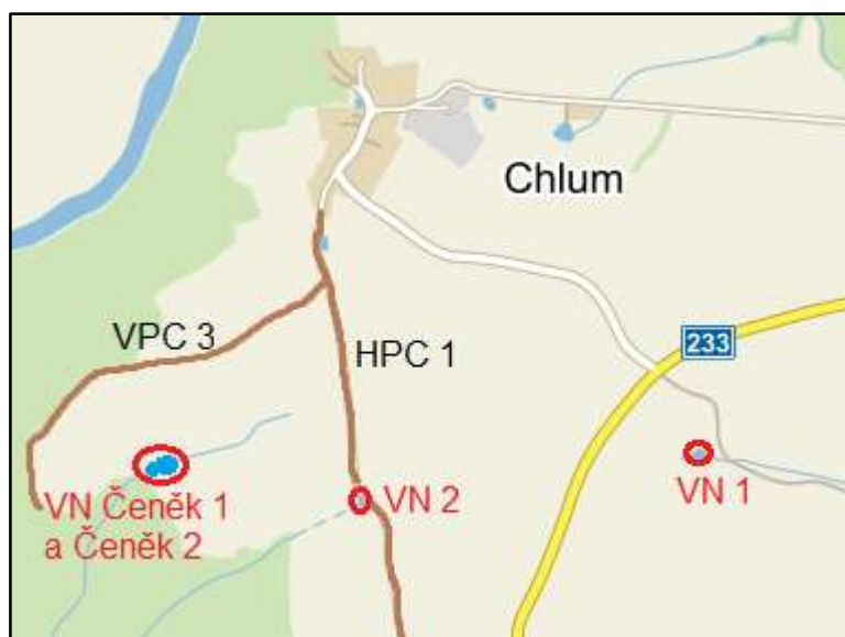
Obr. 2.34: Zrealizovaná opatření v krajině. Rekonstrukce nádrží VN 1 a VN 2, polních cest HPC 1 a VPC 3. Pro VN Čeněk 1 a 2 byl KoPÚ vytvořen pozemek, realizaci provedl vlastník pozemku za pomoci dotací.
