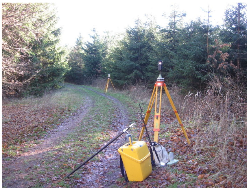
Obrázek 2.4 Vybavení použité při pokusném měření: Totální stanice Trimble S6 a GNSS přijímač Leica řady 1200
