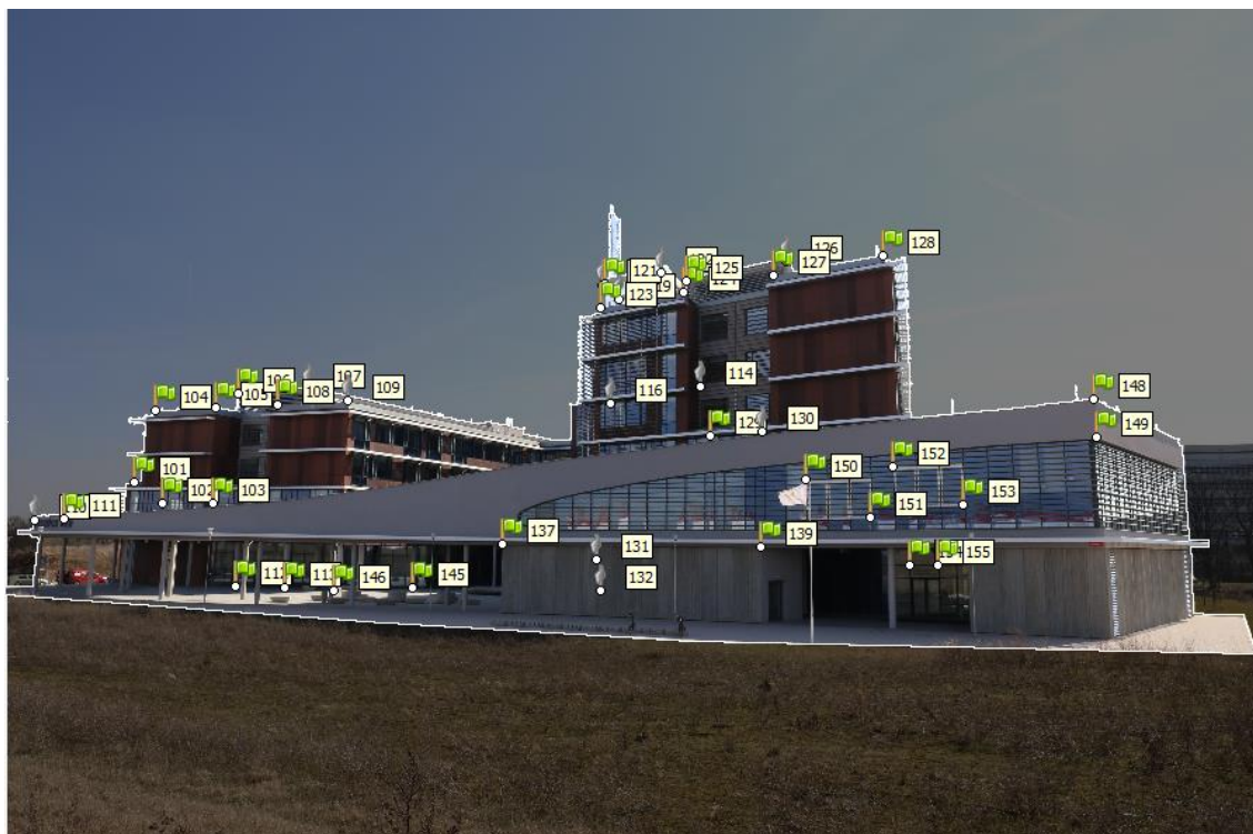
Obrázek 5.10: Ukázka označení vlíčovacích a kontrolních bodů a maskování části snímku v programu Agisoft PhotoScan
