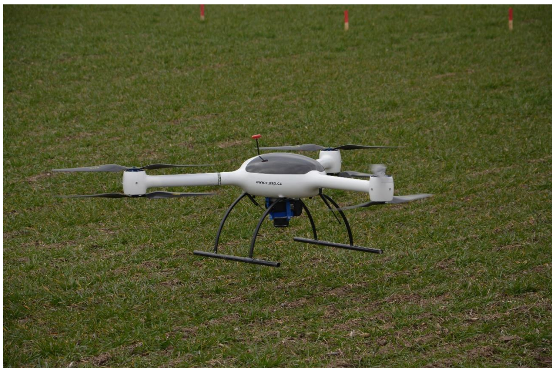
Obrázek 5.1: Multikoptéra typu CUBE Y-6
