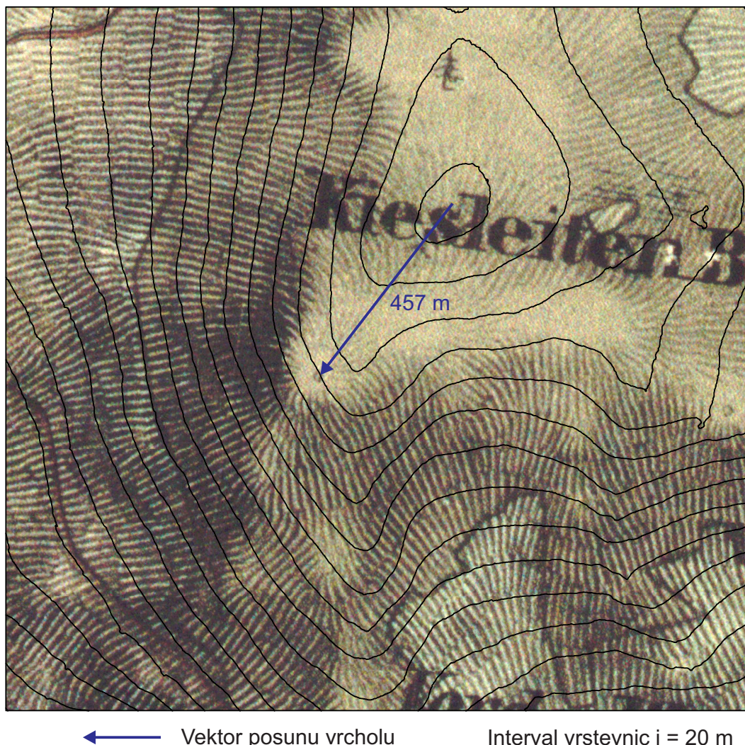
Obr. 5.3: Chybně zaměřený vrchol Křemelné na mapě II. vojenského mapování a skutečný tvar vrcholu znázorněný pomocí vrstevnice vygenerovaných z DMR5G.
