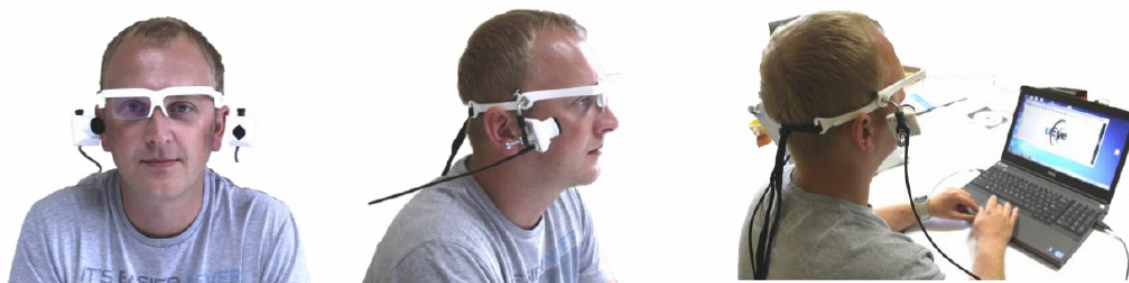
Obrázek 6.2: Způsob používání a zapojení systému I4Tracking ® . [16]
