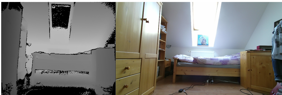
Obrázek 2.4: Rozdílné FOV hloubkového a barevného snímače.
